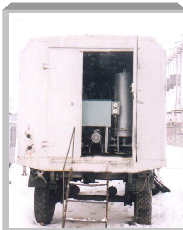
Краткое описание линии ЛВМ-4 (ПУОМ- вариант исполнения и размещения в фургоне) восстановления (регенерации) электроизоляционных свойств трансформаторных масел
