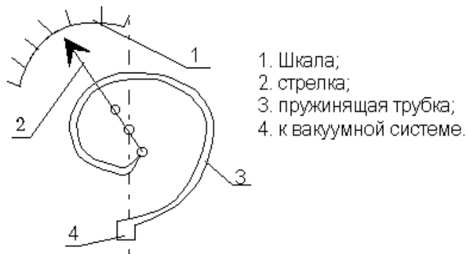
Рис. Схематичное представление манометра Бурдона
